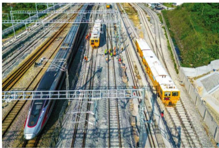
届时,铁路部门将通过检测列车、高速综合检测列车和相关检测设备,在福厦高铁全线对沿线轨道、接触网、通信、信号等各项设备逐项进行测试,并依据测试结果对发现的缺陷进行调整,直至各个系统以及整体系统符合高速运行及动态验收的要求。这相当于一次严格的“体检”,确保线路、设备质量全面达标。
