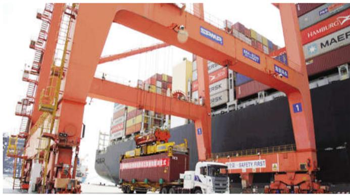
本报讯 据厦门日报报道 日前,全国首个传统集装箱码头全智能化改造项目取得新进展:海润码头智能轮胎式龙门吊投入生产作业。经改造后的龙门吊,除了从卡车上抓、放箱时需人工监控调整外,其余如场内行走、堆叠箱,均由智能系统自动完成。
